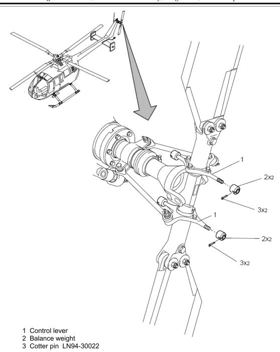
Figure 1 to paragraph (d) Tail Rotor Balance Weights
